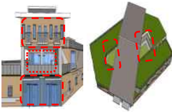
Gambar 18 Banyaknya bukaan dan adanya void pada bangunan
